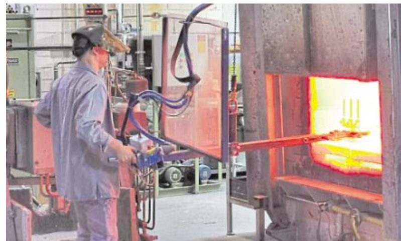
In der Gießhalle werden die im eigenen Haus hergestellten Formen mit flüssigem Metall gefüllt (großes Bild). Auch die Formen müssen gebrannt werden, bevor man sie einsetzen kann (kleines Foto links). Und am Ende steht ein hoch qualitatives Bauteil, zum Beispiel für eine Turbine. Fotos: Kallenbach
