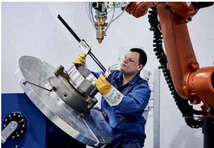
Deloro-Mitarbeiter beim Einrichten der Laserschweißanlage.
